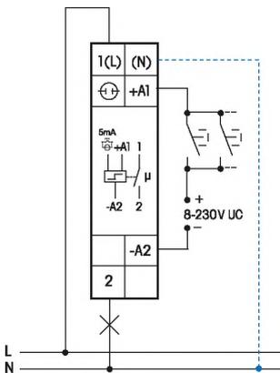
**oder** Steuerspannung 230V mit Glimmlampenstrom bis 5mA
