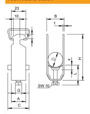
Мав А 23,00 mm Maß B 57,00 mm Мав С 40 mm Maß G M8 Мав Н 129,00 mm Maß L 45,50 mm Maß t 2,00 mm 6,50 mm Мав х Anzahl der Kabel/Rohre 2,00 Max. Anzugsdrehmoment 5,00 Nm für Schiene mit Schlitzweite 16,00 - 17,00 mm Halogenfrei  $\checkmark$ Mit Kunststoffwanne  $\checkmark$ Montageart Profilschiene Schlagfest 46,00 - 52,00 mm Spannbereich D Zusatz Oberfläche feuerverzinkt Zusatz Werkstoff Stahl
