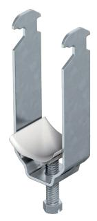
Passend zu allen C-Profilschienen mit 16 - 17 mm Schlitzweite. Schelle und Schraube aus tauchfeuerverzinktem Stahl, Druckwanne aus Polypropylen, halogenfrei, Farbe Lichtgrau RAL 7035.
