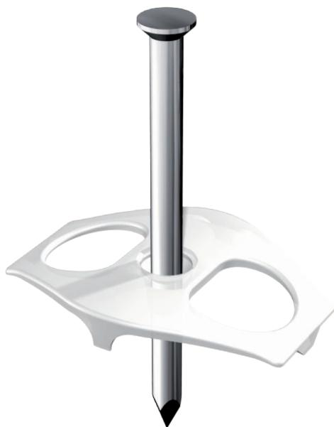
Mit vormontiertem, verzinkten Stahlnagel Ø 3 mm oder 3,5 mm zur Fixierung von Leitungen in Mauerschlitzern und auf Mauerwerk für 1 bzw. 2 Leitungen NYM 3 x 1,5/2,5 mm<sup>2</sup> oder 1 bzw. 2 Leitungen NYM 5 x 1,5/2,5 mm<sup>2</sup>.
