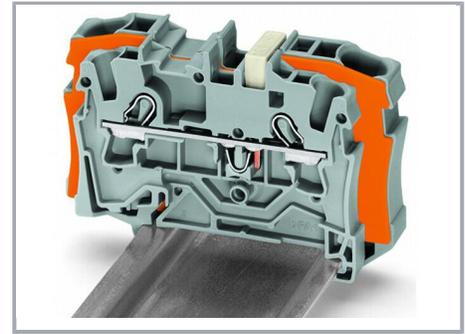
Reduzierbrücken schaffen den Übergang von querschnittsgrößen auf querschnittskleine Durchgangsklemmen, ohne Klemmstellenverlust. Sie sind z. B. interessant, wenn bei großen Leitungslängen der Spannungsfall gering gehalten werden soll, „vor Ort“ aber der Nennquerschnitt ausreicht.
