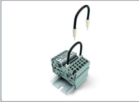
Leitungsbrücker (2009-412) bis zum Anschlag hinunterdrücken. Für Umverdrahtungen Brücker mittels Betätigungswerkzeug heraushebeln.
