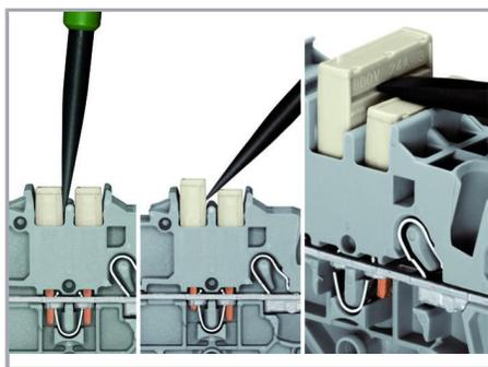
Das Kammbrückersystem beruht auf dem Stecker-Buchse-Prinzip. Jede Klemme ist mit einer Doppelbuchse mit Fremdfederung durch eine Cr-Ni-Stahlfeder ausgestattet. Die Brücke selbst können deshalb aus Elektrolytkupfer besonders klein gefertigt werden. Dennoch sind sie bis zum Nennstrom der Klemme belastbar. Auch PE-Klemmen sind brückbar. Individuelle Brücken entstehen durch Herausbrechen von Kontaktstiften (Serien 2000, 2001, 2002, 2004).
