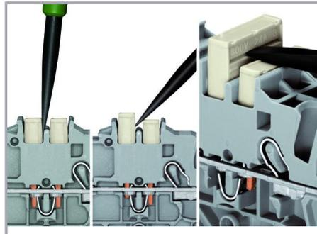
Das Kammbrückersystem beruht auf dem Stecker-Buchse-Prinzip. Jede Klemme ist mit einer Doppelbuchse mit Fremdfederung durch eine Cr-Ni-Stahlfeder ausgestattet. Die Brücker selbst können deshalb aus Elektrolytkupfer besonders klein gefertigt werden. Dennoch sind sie bis zum Nennstrom der Klemme belastbar. Auch PE-Klemmen sind brückbar. Individuelle Brücker entstehen durch Herausbrechen von Kontaktstiften (Serien 2000, 2001, 2002, 2004).
