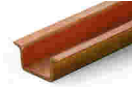
Art-Nr.: 210-198 Kupfertragschiene; 35 x 15 mm; 2,3 mm dick; 2 m lang; ungelocht; entsprechend EN 60715; kupferfarben
