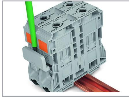
Brücken benachbarter Klemmen mit Querbrückern oberhalb der Leitereinführung, vor Leiteranschluss; der Nennquerschnitt bleibt erhalten.
