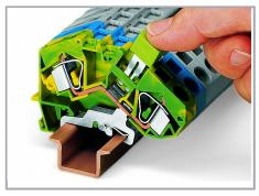
Schutzleiterklemmen lassen sich mit Querbrückern in einer Richtung (über die Klemmenrückwand) mit Durchgangsklemmen brücken. Zusätzlich zur Kennzeichnung dieser Klemmen empfehlen wir die Verwendung der gelbgrünen Querbrücker.
